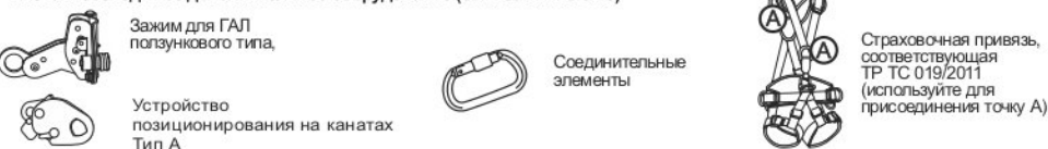
Рис. 3. Необходимое дополнительное оборудование (совместимые СИЗ)
